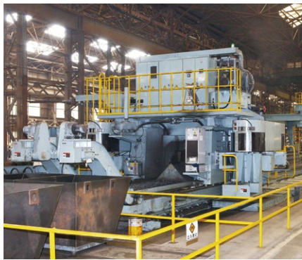
レール用無人加工機 Automatic Rail Machining Center
