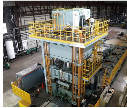
全自動レール鍛造システム (4,000t) Fully Automated Forging System w/ 4,000t Hydraulic
