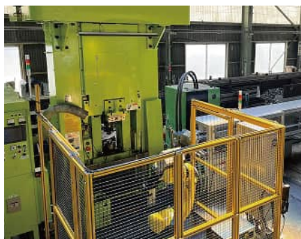
自動頭部成形ライン/システム (150tプレス+自動切断、自動装入) Automated Bolt Head Forming System
