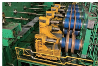
矯正機のロール。更新により、大型製品の寸法と形状の安定性が向上した
