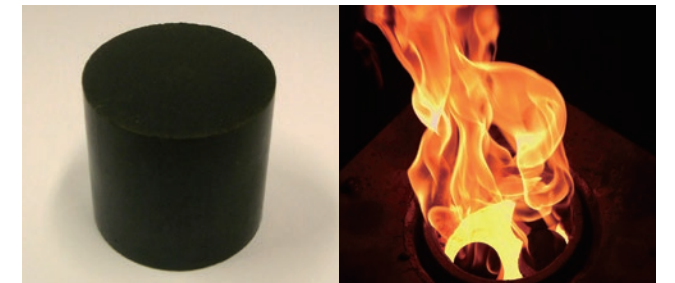
バイオコークスとその燃焼の様子 (出典：近畿大学バイオコークス研究所)
