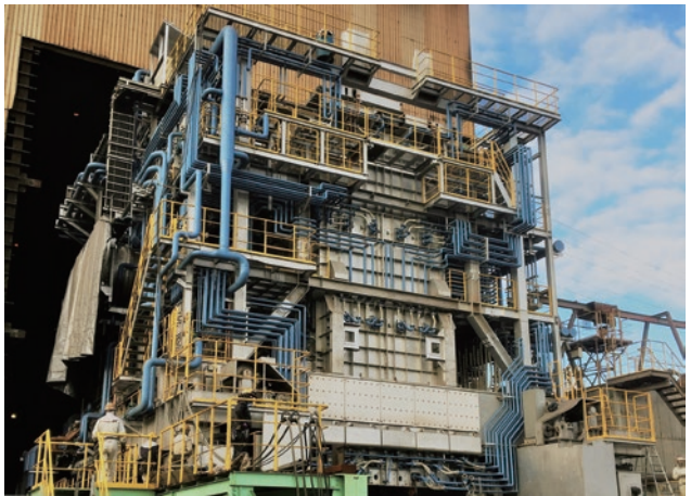
単段式炉頂スクラップ予熱装置（SSP）
