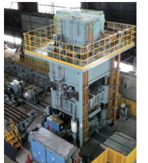
4000トン油圧鍛造プレス機
