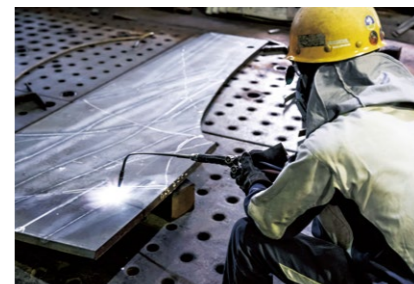
曲げ作業 重工 Bending
