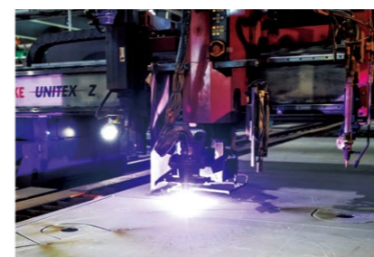
鋼板NC切断 重工 Steel Plate Cutting
